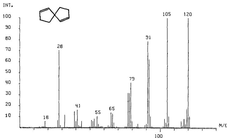
Fig. 2. Massenspektrum des (+)-1,6-Spiro[4.4]nonadiens (Hitachi-Perkin Elmer RMU-6 A, Ionen-tensionsspannung 70 eV)
